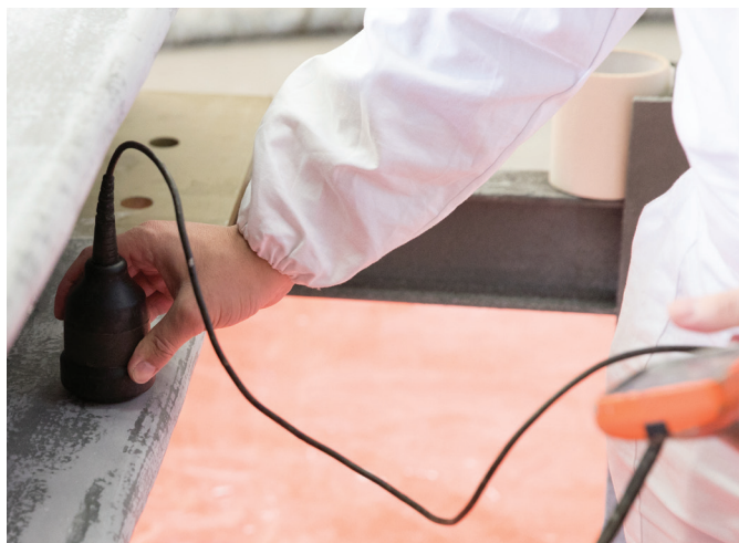
PPG PITT-CHAR NX tiene únicamente 7.98mm (314 mils) de espesor para aplicaciones UL 1709 de dos horas
